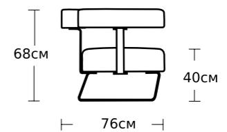
Корпус - шперплат; Крака - стомана с ПВЦ покритие; Пълнеж на седалката - пенополиуретан; Пълнеж на облегалката - пенополиуретан; Гаранция на конструкцията - 2 години.
